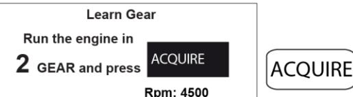
N.B.: Poiché durante l'apprendimento sul cavalletto è necessario avere un rapporto più stabile possibile si consiglia di premere leggermente il freno posteriore durante la memorizzazione in modo da ridurre al minimo le oscillazioni della trasmissione.
