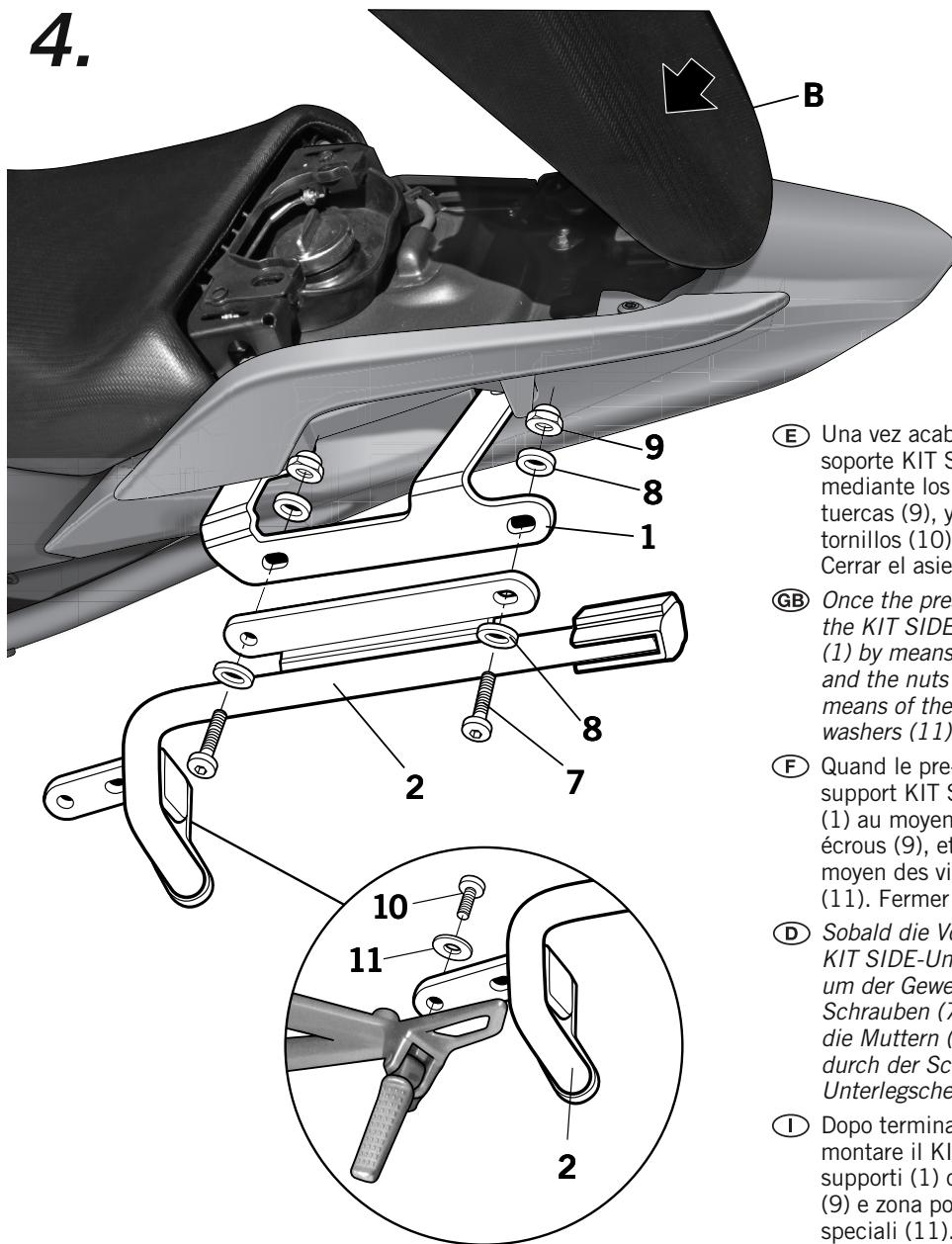
(E) Una vez acabado este premontaje, montar los soporte KIT SIDE (2) a los soportes unión (1) mediante los tornillos (7), las arandelas (8) y las tuercas (9), y en zona estribera mediante los tornillos (10) y las arandelas especiales (11). Cerrar el asiento delantero (B).
