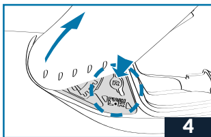
4 – Na obou bočních destičkách mechanismu po stranách hledí najdete tlačítko označené «R» (pravá strana) a «L» (levá strana).
